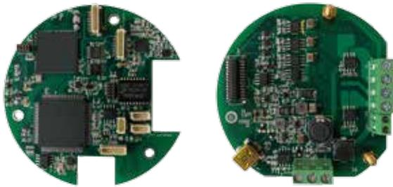
高性能、小巧緊湊的直流伺服驅控系統，為關節模組的控制核心。
