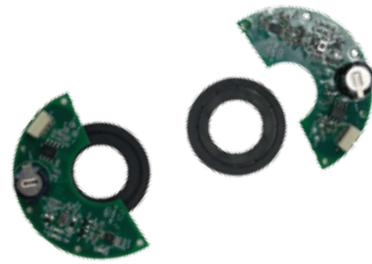
內建高精度絕對型編碼器，雙編碼器設計，實現精密的協作型機械手臂控制。
